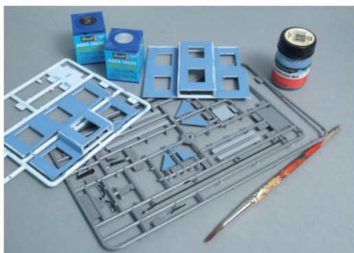
Die Fassadenteile wurden teilweise in Baugruppen zusammengebaut und teilweise noch an den Spritzlingen mit der neuen Farbe lackiert.
