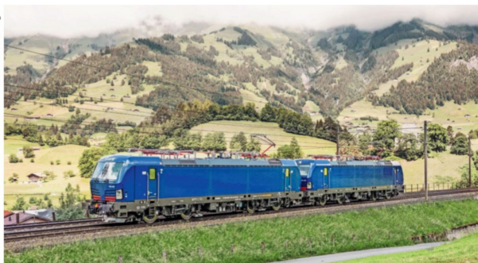
Am 1. Juni 2018 fanden die Abnahmefahrten der beiden 193 490 und 491 von Spiez via Kandersteg nach Brig und wieder zurück statt. Die 193 491 wirkte als Zug- und die 490 als Bremslokomotive.
