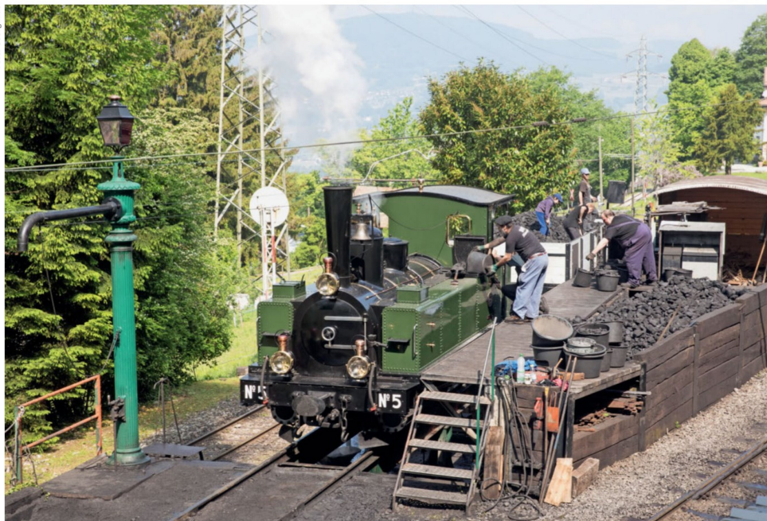
Als wäre die Zeit in Chaulin stehen geblieben, werden den Dampflokomotiven, wie hier bei der LEB G 3/3 Nr. 5, von Hand die Vorräte ergänzt.
