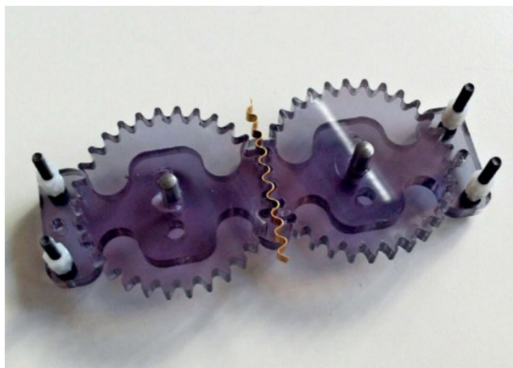
Das Formen der Zahnstangen geschieht durch gezahnte Räder aus Plexiglas.
