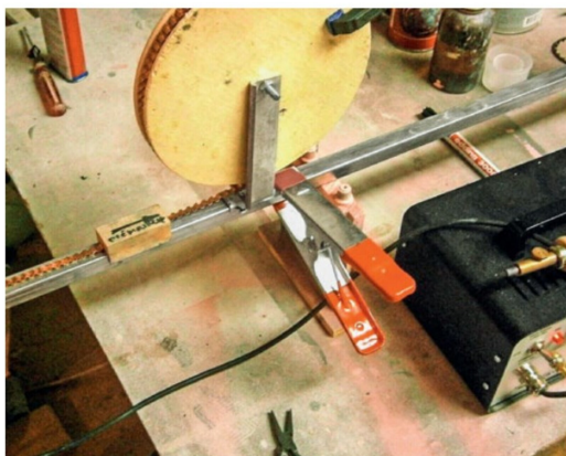
Die «Verteilerrolle» der Zahnstange auf dem verzinkten Gleis.
