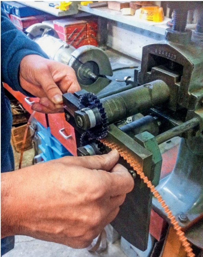
Auch die Zahnstange wird mittels einer Biegemaschine selbst hergestellt.
