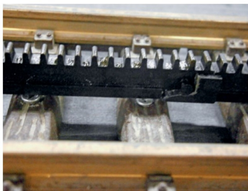
Wegen der fehlenden Durchsicht wird die LGB-Zahnstange nicht verwendet.
