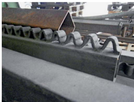
Eine Detailsicht der selbst erstellten und verwendeten Zahnstange.
