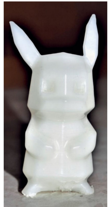
Ein 3-D-gedrucktes Pokémon aus ABS, das anschliessend mit Acetondampf geglättet wurde.
