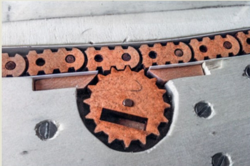
Die Kette mit Antriebszahnrad vor dem Abdecken durch den «Meeresgrund».
