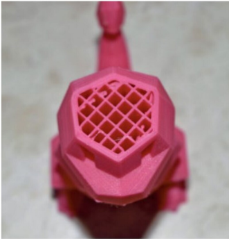
3-D-gedruckte Objekte werden meist zusätzlich innen befüllt, um die Stabilität zu gewährleisten.
