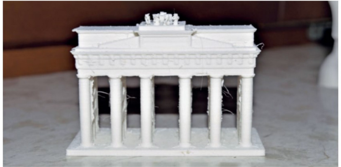
Ein 3-D-gedrucktes Objekt aus Laybrick, einem sandsteinartigen Filament. Wie man auf dem Bild sieht, lassen sich feinste Details kaum darstellen, und es kommt vermehrt zur Bildung von Fäden.
