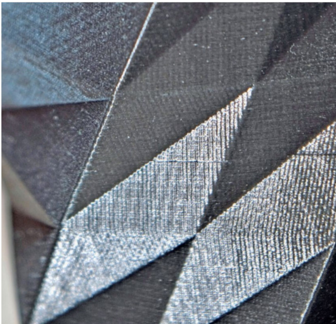
Auf diesem Bild kann man die einzelnen Schichten bei minimaler Schichtdicke (0,05 mm) immer noch erahnen – das ist klassisch für Fused Deposition Modeling (FDM-3-D-Druckverfahren).
