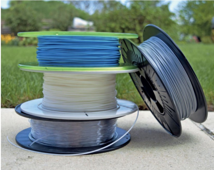
Das Druckmaterial (Filament) für FDM-3-D-Drucker wird meist auf Spulen geliefert.
