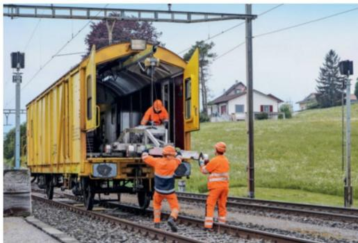
Auf einem sanierten Gleisabschnitt in der nördlichen Einfahrt von Ossingen wurde am 4. Mai 2018 die Gleissteifheit geprüft, das heisst, ob sich die Einsenkung beim Drüberfahren innerhalb der vorgegebenen Werte bewegt.
