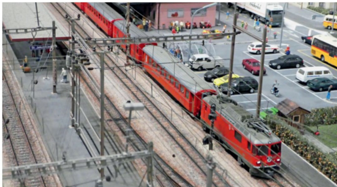
Ge 4/4 II , 1650 kW, 50 t, Last: 32 Achsen, 384 Plätze, 181 t, V/max 90 km/h.
