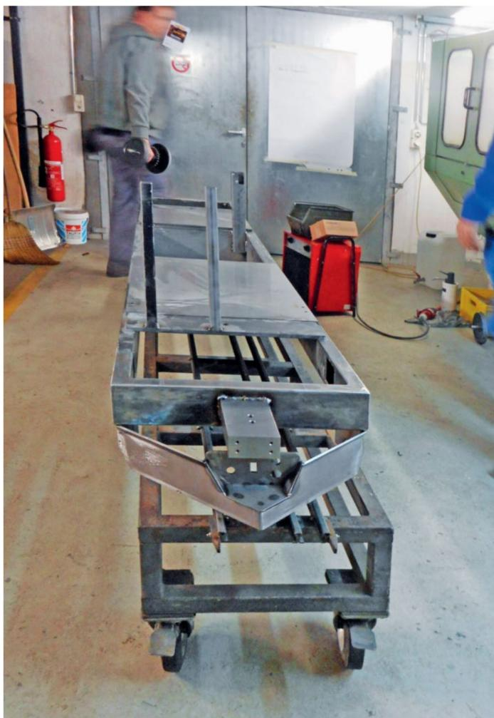
Die Arbeiten sind im Gang: Bahnräumer und Kupplungshalterung, abgeändert gemäss MOB-Vorbild.
