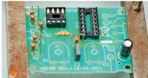
Die ersten Bauteile befinden sich auf der Platine. Die Widerstände sind bis auf ein Exemplar stehend angeordnet. Man beachte die Farbringe respektive deren Wert am Aufdruck an der Platine. Besondere Beachtung verdienen der Elektrolytkondensator, der polrichtig eingesetzt werden muss, sowie die Richtung der IC-Fassungen.
