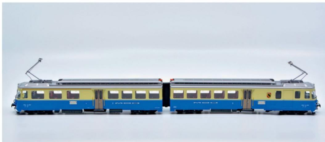
Verglichen mit dem Vorbild ist sicherlich der Abstand zwischen den beiden Triebwagenhälften ein wenig zu gross, er erhöht jedoch die Betriebssicherheit.
