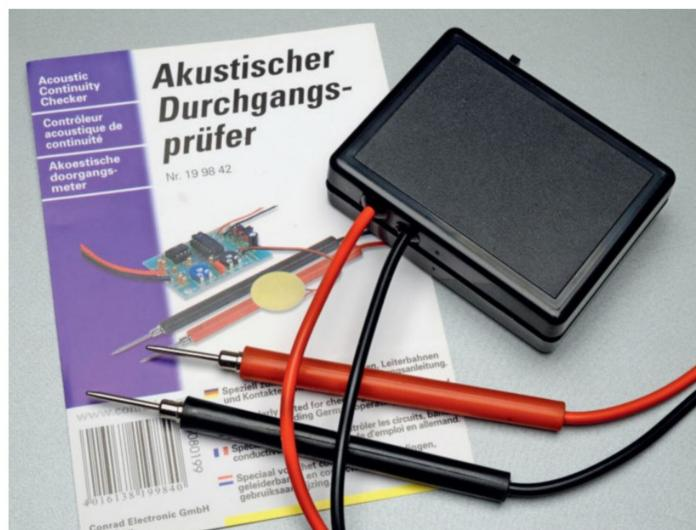
Conrad bietet zum akustischen Durchgangsprüfer auch ein passendes Gehäuse an, an dem Aussparungen für den Schalter und die Tüllen zur Kabeldurchführung anzubringen sind.
