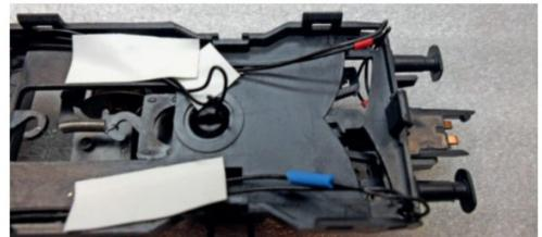
Hier die Kableinführung von der Kupplung in den Wagenkasten.
