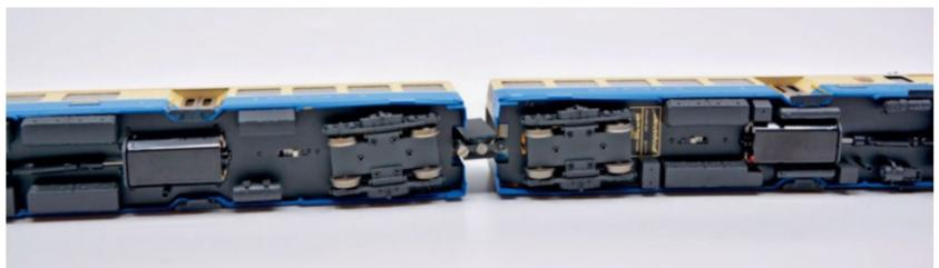
Ein weiterer Blick auf den Unterboden zeigt die beiden Fahrmotoren und die Schalter zum Umschalten von Analog- auf Digitalbetrieb.
