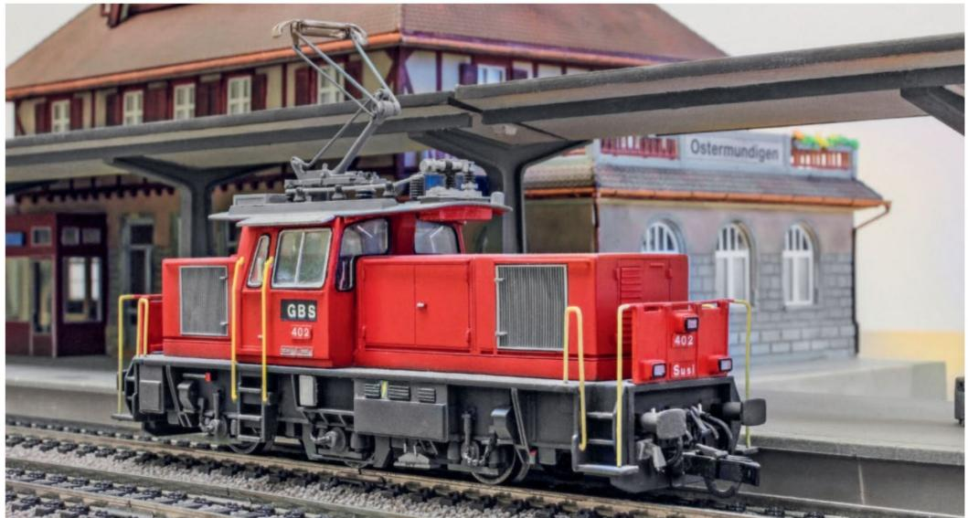
Dieser Lokomotivtyp stammt von der Ee-3/3-Bauserie ab, welche 1991 hergestellt wurde. Anders als die üblicherweise mit Stangenantrieb gebauten Ee-3/3-Rangierlokomotiven verfügen diese Lokomotiven über einen Einzelachsantrieb. Die GBS benötigte eine leistungsfähige Rangierlokomotive, die ebenfalls im Streckendienst eingesetzt werden (V/max 75 km/h) und fahrleitungslose Anschlussgleise bedienen konnte. Des-
