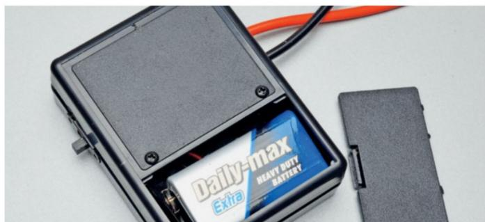
Das zum Durchgangsprüfer angebotene Gehäuse weist ein Batteriefach mit Schnappverschluss auf.
