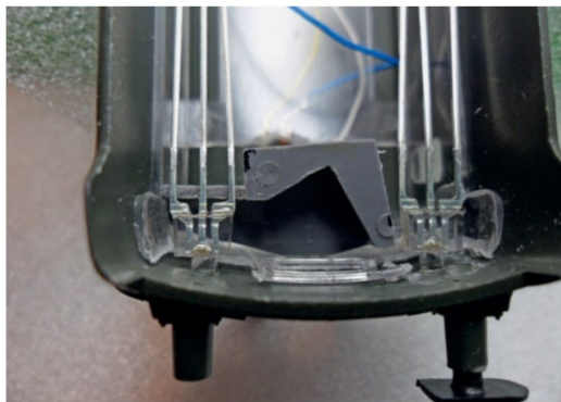
Für den Einbau der LED musste bei den Frontlampen gefräst werden.
