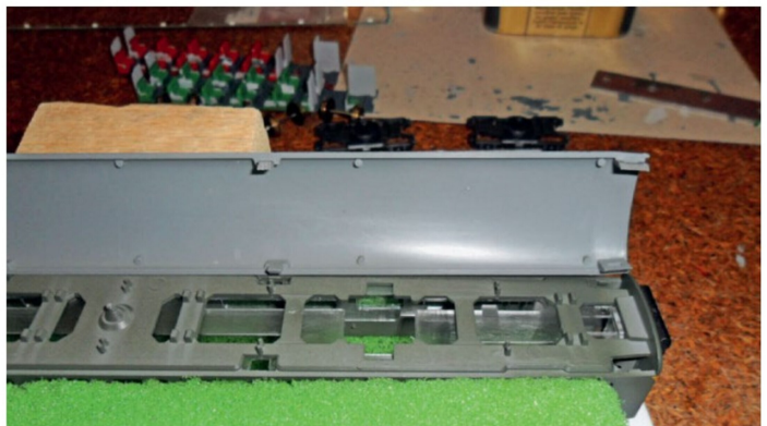
Die Demontage des Dachs ist schon eher eine Fuseslei, und die Rastnasen können leicht abbrechen.
