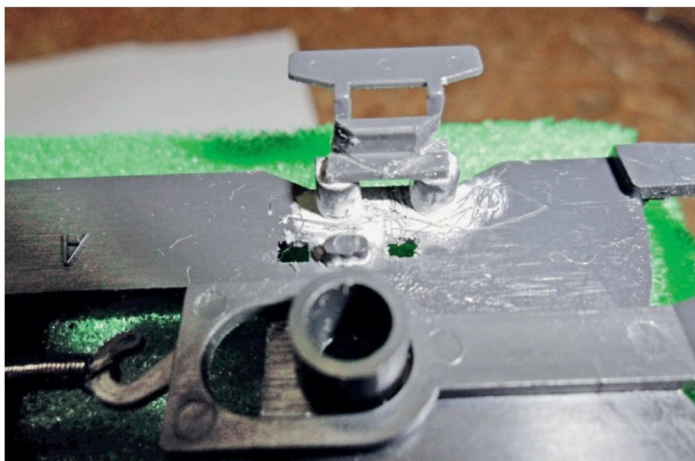
Am Trittbrett-Bauteil müssen beidseitig 45°-Kanten weggefeilt werden.
