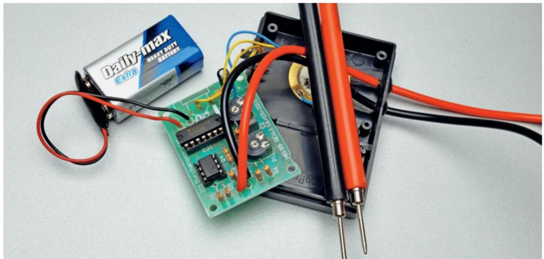
Nach der letzten Überprüfung und dem Einsetzen der ICs wird die Batterie angeschlossen und der Schalter betätigt. Nun erfolgt der Abgleich. Der Piezo-Summer ist mit Uhu-Alleskleber am Gehäusedeckel fixiert.
