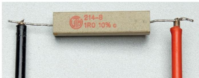
Der Abgleich des Durchgangsprüfers erfolgt mit einem Widerstand, der einen Wert von 1 Ohm aufweist. Der Widerstand im Bild dient zur Strombegrenzung bei Halbleiterschaltungen, daher sein Volumen. Das Trimpotentiometer mit der Bezeichnung P 1 wird so weit im Uhrzeigersinn gedreht, bis ein Summton hörbar wird. Mit dem Potentiometer P 2 wird die Lautstärke respektive die Frequenz des Tons eingestellt.
