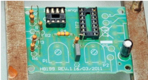
Die ersten Bauteile befinden sich auf der Platine. Die Widerstände sind bis auf ein Exemplar stehend angeordnet. Man beachte die Farbringe respektive deren Wert am Aufdruck an der Platine. Besondere Beachtung verdienen der Elektrolytkondensator, der polrichtig eingesetzt werden muss, sowie die Richtung der IC-Fassungen.
