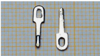
Zuerst die Verbindung anlöten, da in umgekehrter Folge das Lötzinn an der Platine schmilzt und keine korrekte Verbindung mehr gewährleistet.
