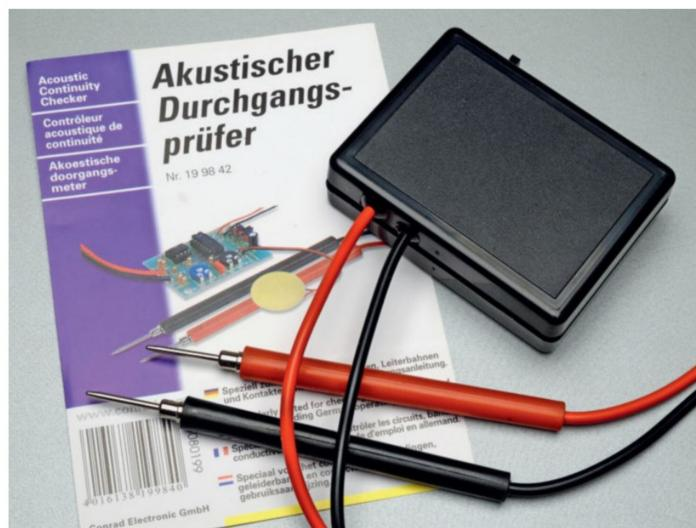
Conrad bietet zum akustischen Durchgangsprüfer auch ein passendes Gehäuse an, an dem Aussparungen für den Schalter und die Tüllen zur Kabeldurchführung anzubringen sind.
