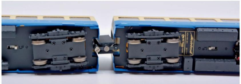
Die beiden Hälften werden mittels eines verschraubten Kupplungsstücks miteinander verbunden.
