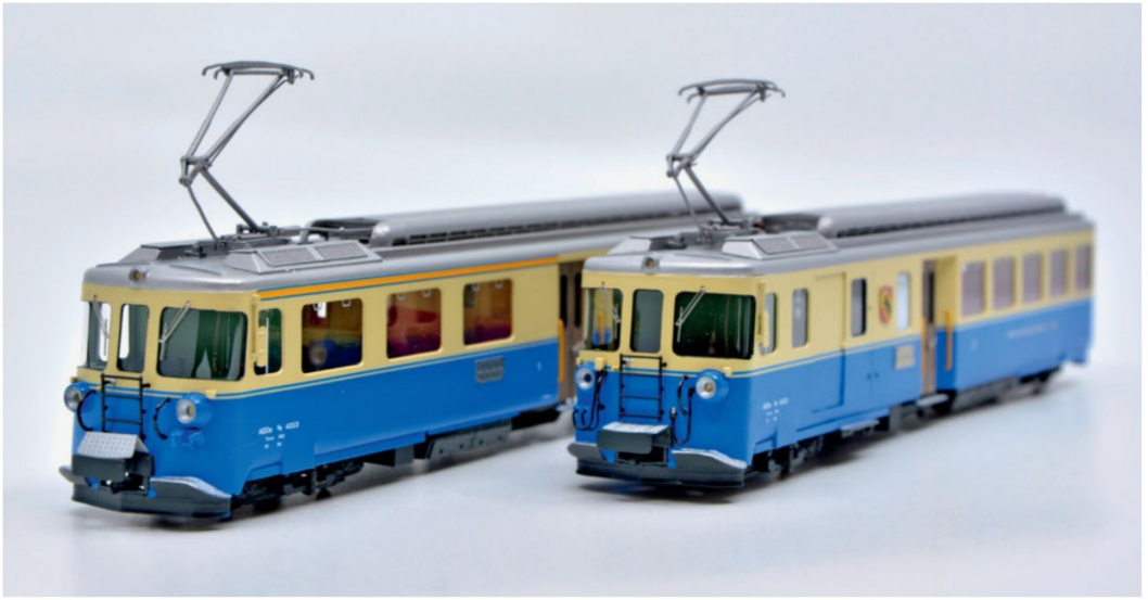
Beide Triebwagenhälften im Stelldielein nebeneinander. Beide Hälften sind identisch, wobei die eine das Erstklass- und die andere das Gepäckabteil aufweist.
