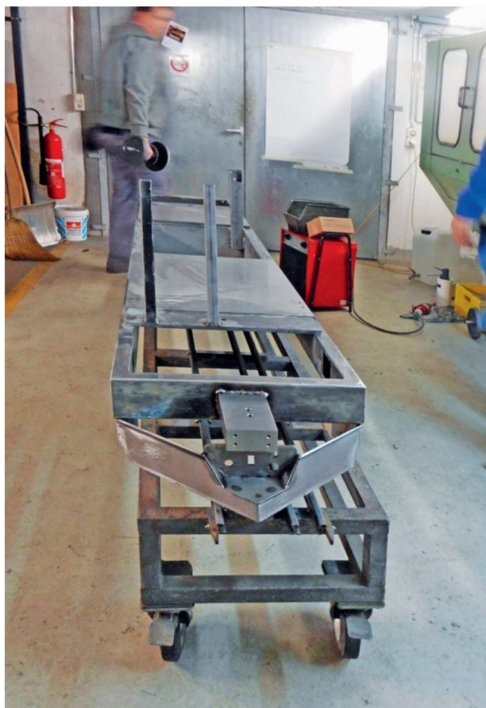
Die Arbeiten sind im Gang: Bahnräumer und Kupplungshalterung, abgeändert gemäss MOB-Vorbild.
