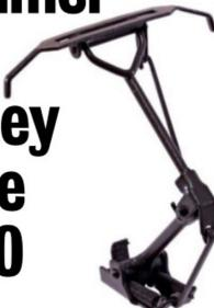
Der Oberleitungs- und Pantografenhersteller Sommerfeldt bietet für die Schweizer Re 460 neu einen Faiveley-Stromabnehmer (Art.-Nr. 698) an. Der Stromabnehmer ist insbesondere für Modelle von Hag und Märklin gut geeignet und durch seine Robustheit auch für echten Oberleitungsbetrieb.
