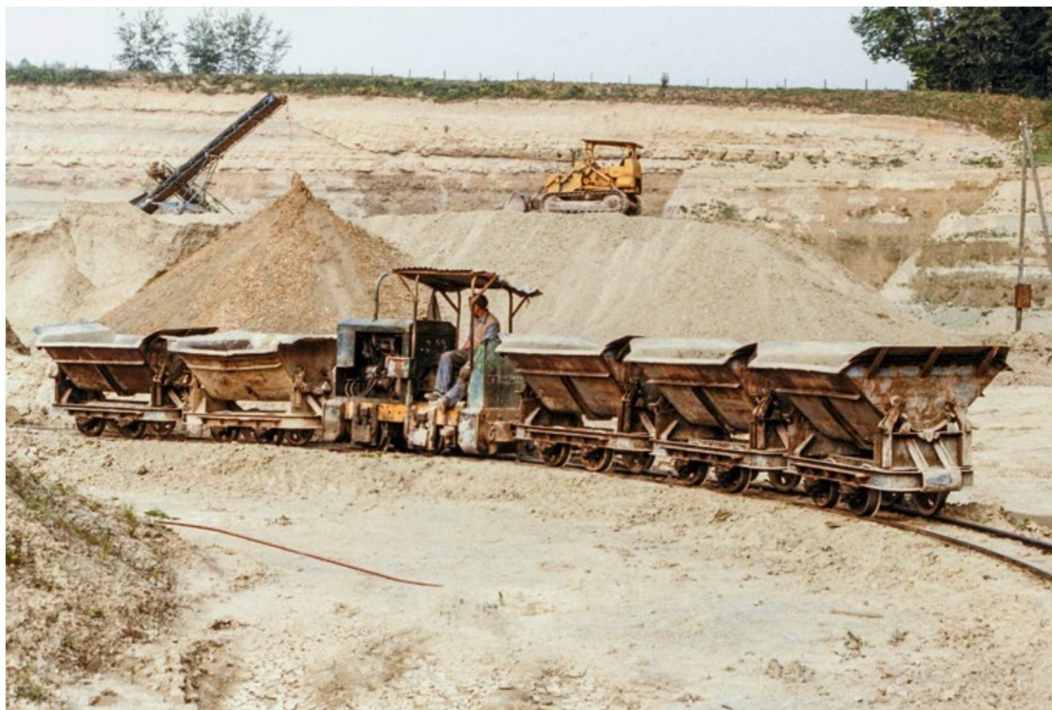
Einst waren Feldbahnen das Massentransportmittel auf Baustellen, Kiesgruben, Bergwerken oder wie hier in der Ziegelei Lufingen.
