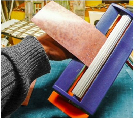
Eine solche Prägerolle gibt es im Bastelbedarf. Gut geeignet für Wellblech.
