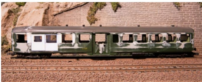
Fertig gespachtelt und bereits geschliffen zeigt sich der BD 231 von der Seite.
