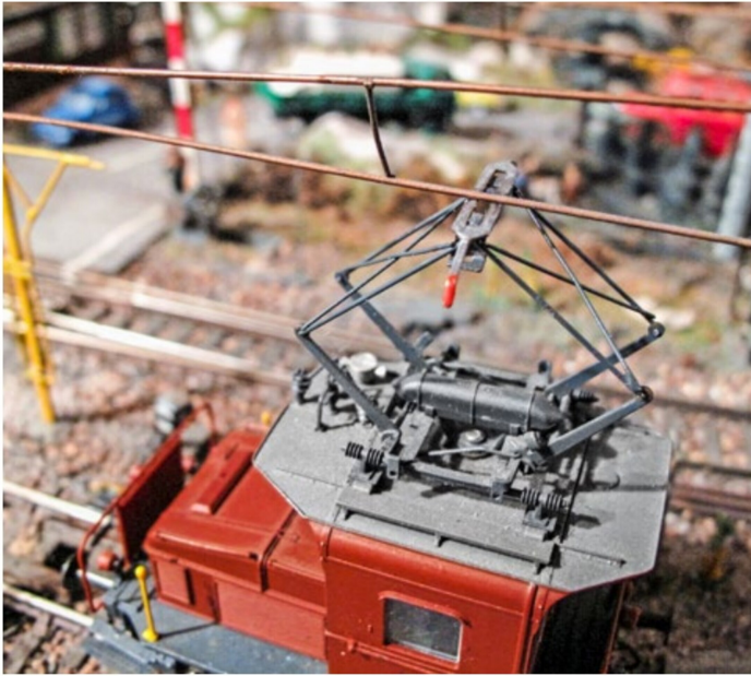
Der Pantograf erhielt ein neues Schleifstück der Schweizer Bauart aus dem Sommerfeldt-Sortiment.
