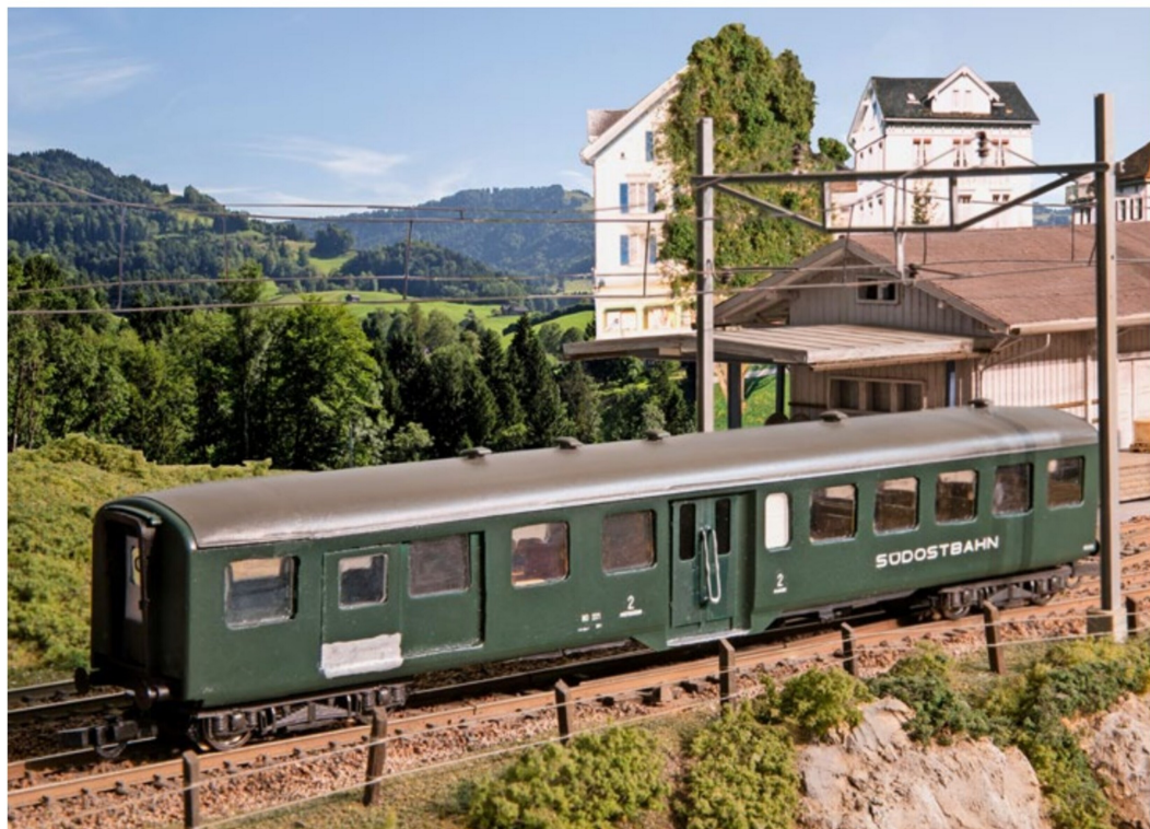
Der fertiggestellte BD 231 im Stil von 1973 posiert für den Fotografen in Ebnet-Kappel. Auffällig sind die SOB-typischen Geländerstangen bei den Einstiegen.
