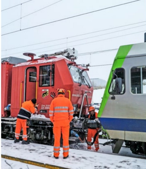
Nach Abfahrt des Regelzugs wurde der Lös- und Rettungszug am defekten RBDe 566 II 230 angehängt. Nach der Bremsprobe und dem Einrichten der Schleppstellung musste nur noch der Gegenzug abgewartet werden.
