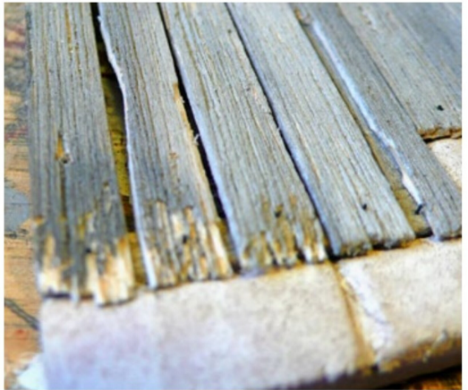
Ausgefrante Brettenden werden mit dem Skalpell vorsichtig eingezitt.
