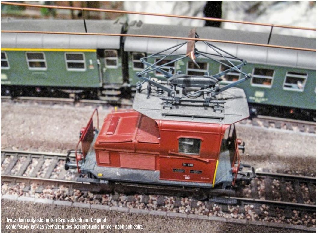
Der Pantograf erhielt ein neues Schleifstück der Schweizer Bauart aus dem Sommerfeldt-Sortiment.
