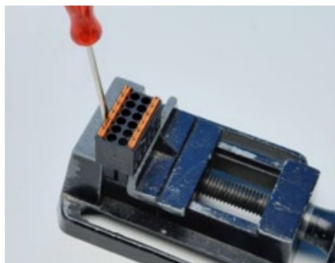
Ein kleiner Schraubstock ist eine praktische Hilfe beim Fixieren der Leitungen im Steckverbinder.
