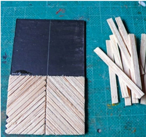
Fein geschnittene Balsaholzbrettchen für die Türen werden aufgeklebt.
