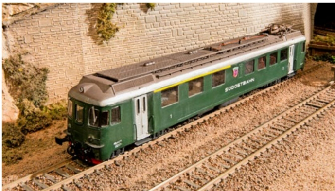
Der ABe 4/4 71 im Ursprungszustand. Deutlich ersichtlich: die Widerstandsaufbauten und Dachleitungen.
