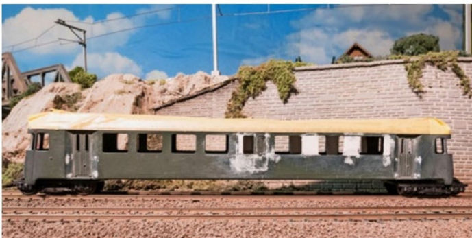
Auf der anderen Triebwagenseite sieht man eine andere Anordnung der Lüfteröffnungen.
