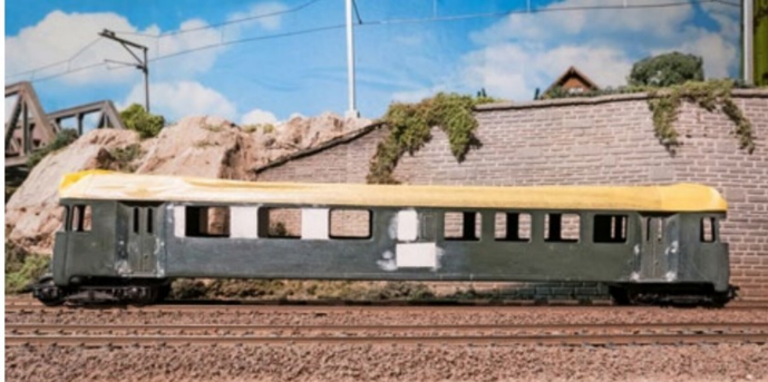
Der Triebwagenkasten ist nun fertig gespachtelt. Deutlich erkennt man die geänderte Fensterteilung.
