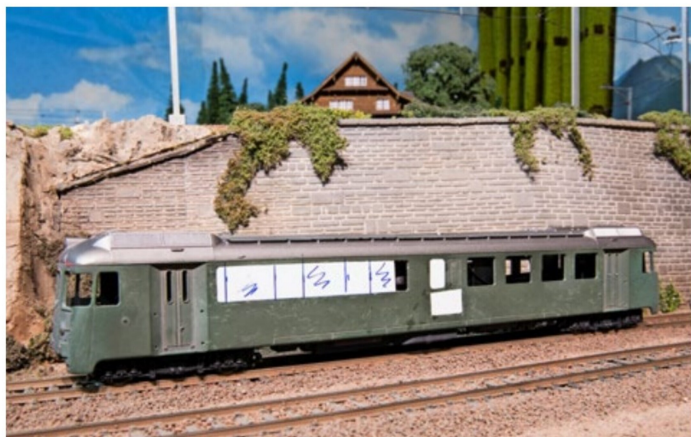
Dem Triebwagenkasten wurde ein Polystyrolstreifen eingesetzt, und die Fenster wurden angezeichnet.
