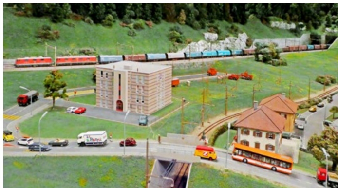
Triebfahrzeuge: Re 10/10, 200 t, 12,5 MW; Last: 76 Achsen, 1400 t; Vmax: 100 km/h.
