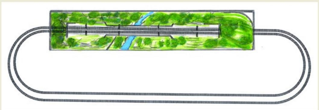
Das Diorama ist in einem Doppelgleisoval eingebettet. Jedes Gleisoval kann separat für die Programmierung der Lok-Decoder genutzt werden.
