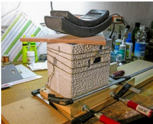
Alle Öffnungen hergestellt. Die Wände verleimen, dazu stecken sie im «Zwinger».
