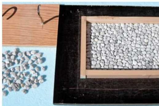
Urform für die Abgüsse der Bollensteinmauer erstellen.
