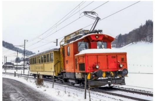
Spezieller war die Komposition des Vereins Dampfbahn Bern (DBB) anlässlich einer Charterfahrt. Sie bestand aus dem einstigen BLS-Fahrleitungs-montage-Traktor Tem 225 056 und dem Bi 523 «Sennhütte» (ex EBT).
