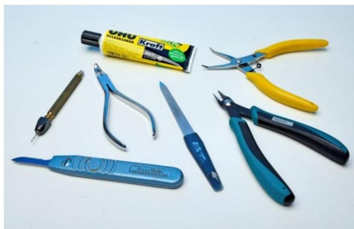
Hilfreiche Werkzeuge für das Zurüsten von Fahrzeugen. Der Kleber ohne Lösungsmittel hinterlässt bei zu üppigem Auftrag keine Spuren am Lack und kann mühelos entfernt werden.
