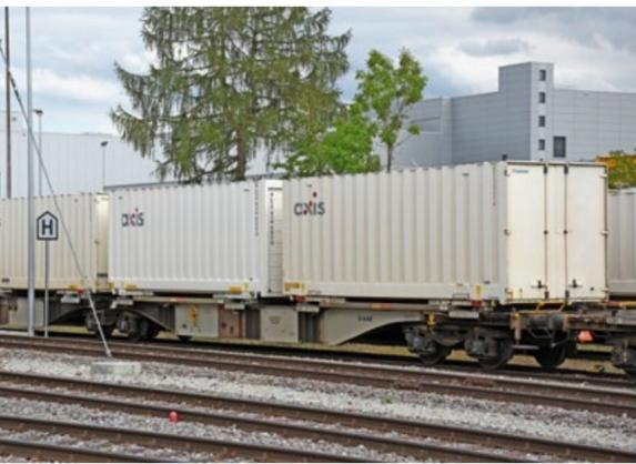
Typenbild eines Doppeltragwagens Sggmrss. Gut sichtbar sind die horizontalen Streben auf den Seitenwangen im Bereich der Containerverschubbahnen.
