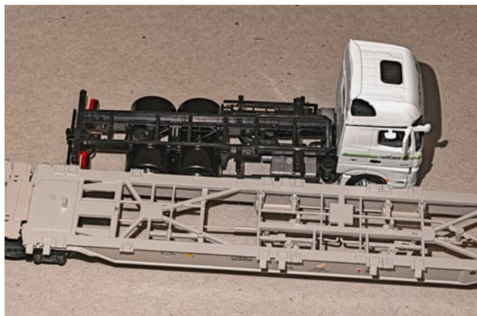
Bei der Gegenüberstellung von Roco-Tragwagen und AWM-Lastwagen werden die unterschiedlichen Befestigungssysteme für die Wechselbehälter sichtbar.
