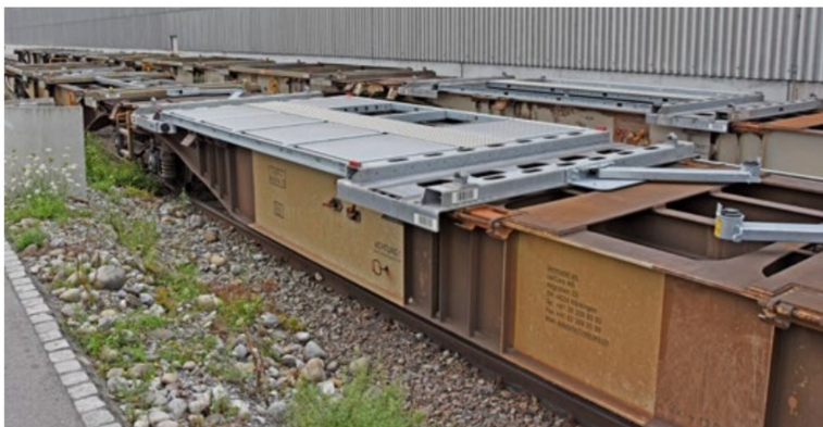
Ein AAE-Tragwagen mit einem sogenannten rCE-Powerpack. Gut sichtbar sind die Akkus und die Steckdosen für den Stromanschluss der zu beladenden Kühlcontainer.
