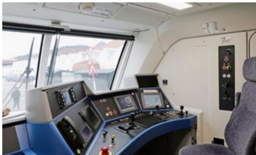
Wenn sich der Lokführer ans Eingangstürfenster stellen muss, ist ganz rechts das Bedientableau für Rangierfahrten ersichtlich.
