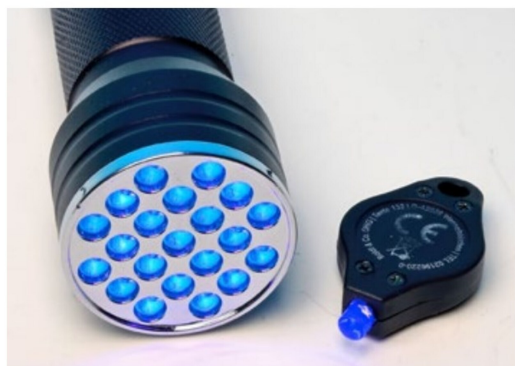
Zwei UV-Lichtquellen, die sich zur Verarbeitung des UV-Klebers eignen: ein kleiner Beamer mit LED und eine Taschenlampe für grössere Klebeflächen.
