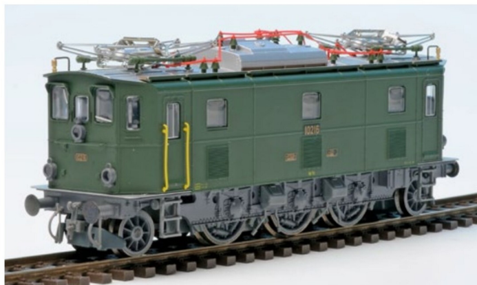
Bei der Zurüstung der Ae 3/5 ist die Befestigung der Sandkästen samt den Fallrohren nicht ganz unproblematisch, da keine Rasteinrichtungen vorhanden sind. Die Steuerleitung ist noch zu ergänzen. Ihre Position ist das seitliche Loch am Pufferträger.
