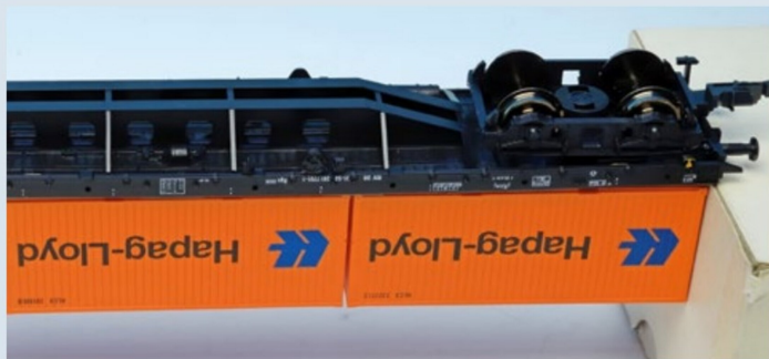
Auch am älteren PIKO-Tragwagen werden die Container mit dem Fotokleber fixiert.
