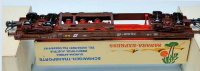
Nach dem Auftragen des Fotoklebers in die Radwannen wird der Sattelaufleger eingesetzt und der Zapfen vorne eingerastet. Etwa 20 Minuten später ist die Haftung ausreichend.
