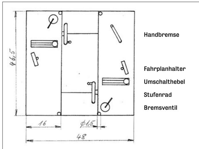
Anordnung und Benennung der einzelnen Führerstandsaggregate.
