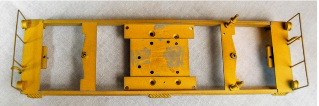
So sieht das fertige Untergestell aus. Bereits montiert sind die Bühnengeländer, die Luftleitungen und die Frontlampen.
