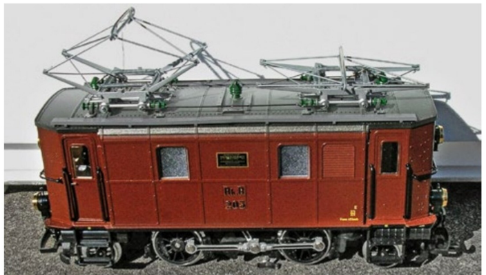
Panto 1 ist an der fiktiven Fahrleitung angelegt, Panto 2 abgesenkt in Ruhestellung.
