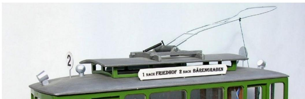
Die Lyra-Stromabnehmer wurden im Vorbild mittels Seilen gesenkt und gehoben, von daher stört der Draht überhaupt nicht.
