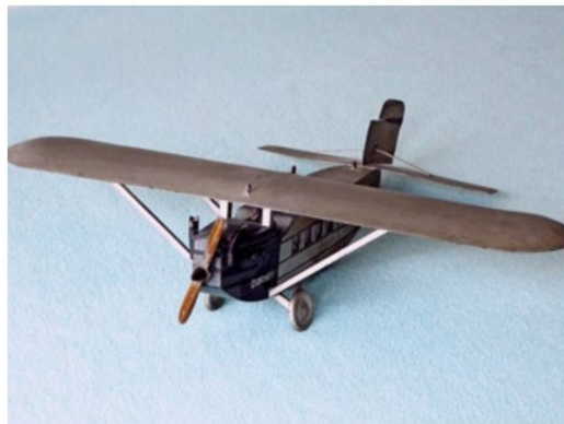
Die Dornier Merkur mit einer Flügelspannweite von 46 cm, Einstiegstür zum Öffnen, verglasten und mit Vorhängen bestückten Fenstern sowie einer Innenbeleuchtung; die Lampenfassung befindet sich unter dem Deckel auf dem Flügel. Der Massstab ist ca. 1:43.
