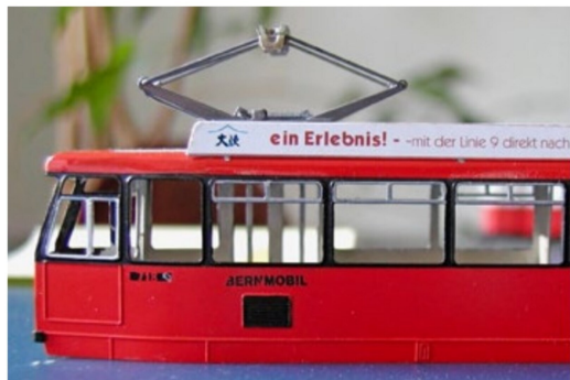
Detail der Beschriftung eines Kastens des Be 8/8 718. Die Nummer, das Wappen und das Bernmobil-Logo entstanden in Anreibeschrift. Die mehrfarbigen Reklamen entstanden als Nassschiebedild.
