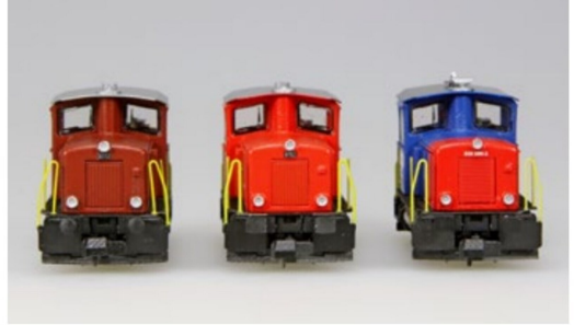
Der Blick auf die Front zeigt die unterschiedlichen Kühlergittervarianten.
