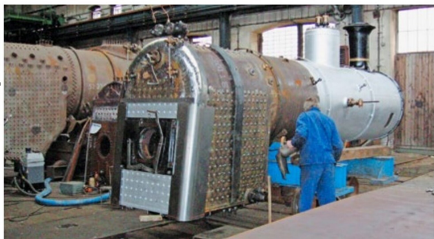
Geschweisster Kessel in der Werkhalle neben Altbaukessel Nr. 3 und Kessel der Baureihe 52.221.
