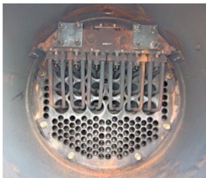
Rauchkammerwand, unten Siederohre, oben Überhitzerrohre.
