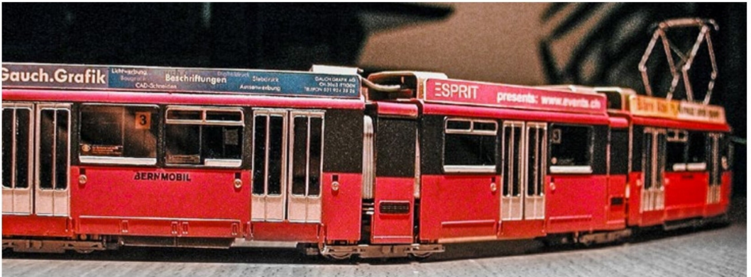
Be 8/8 718. Blick auf ein Detail: das Gelenk. Beim Befahren von Kurven öffnen sich die Kästen im Gelenkbereich. Vorbildrichtig wurden Faltenbälge eingesetzt.
