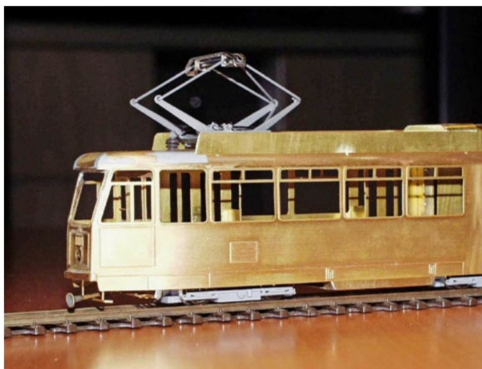
Be 8/8 im Rohbau. Ausser den Drehgestellen ist das gesamte Fahrzeug aus Metall gefertigt.
