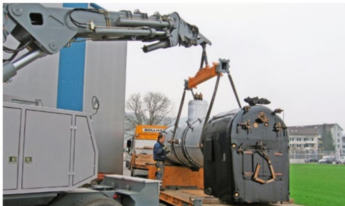
Ankunft aus Ceské Velenice in Weinfelden bei Bollhalder: Ablad mit Spezialkran zur Montage aufs Fahrwerk.
