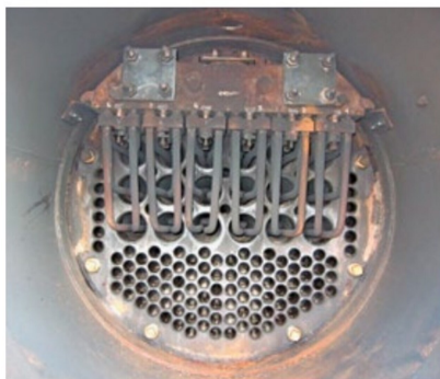
Rauchkammerwand, unten Siederöhre, oben Überhitzerrohre.
