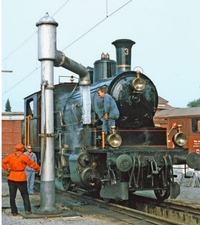
Beim Wasserfassen im Depot Wil. 15.7.1978. Kessel- und Zylinderverkleidung in Blaublechimitation.
