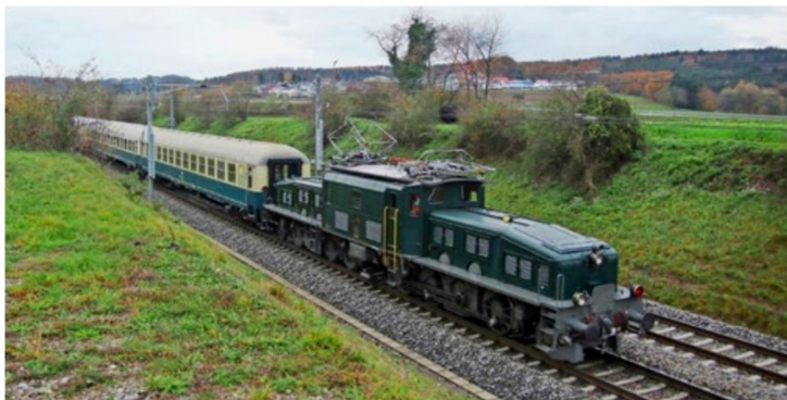
In der Schweiz wurden die historischen Lokomotivlampen wieder angebracht und der andere Stromabnehmer mit der Schweizer Wippe verwendet. Der Nachschuss entstand bei Jetstetten.
