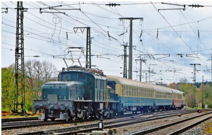
Im Gegensatz zu den Auslandsfahrten von 2015 kehrt die Ce 6/8 ohne Lampen zurück. Bei der Ausfahrt von Singen als Schlussläufer fällt das aufgesetzte breite Schleifstück unter der DB-Fahrleitung auf.
