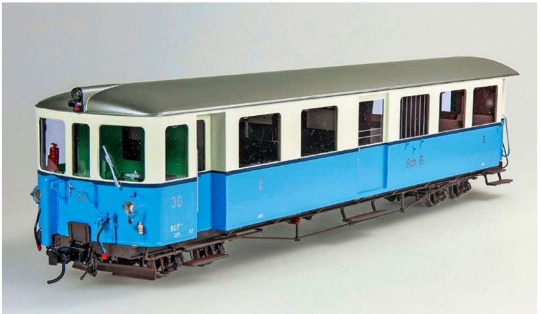
Der 1943 aus dem Personenwagen ABF4 Nr. 33 umgebaute, vollwertige Steuerwagen mit der Bezeichnung ABF4 30 und den chromfarbenen Bahninitialen SchB. Dieses Modell wurde wiederum mit grossem Aufwand bei der Detaillierung dem Vorbild entsprechend nachempfunden..
